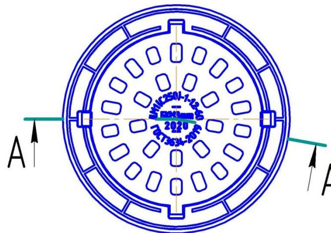
Рис.1. Дождеприемник магистральный ДМ1-С250-1-12-60 (РВ).
