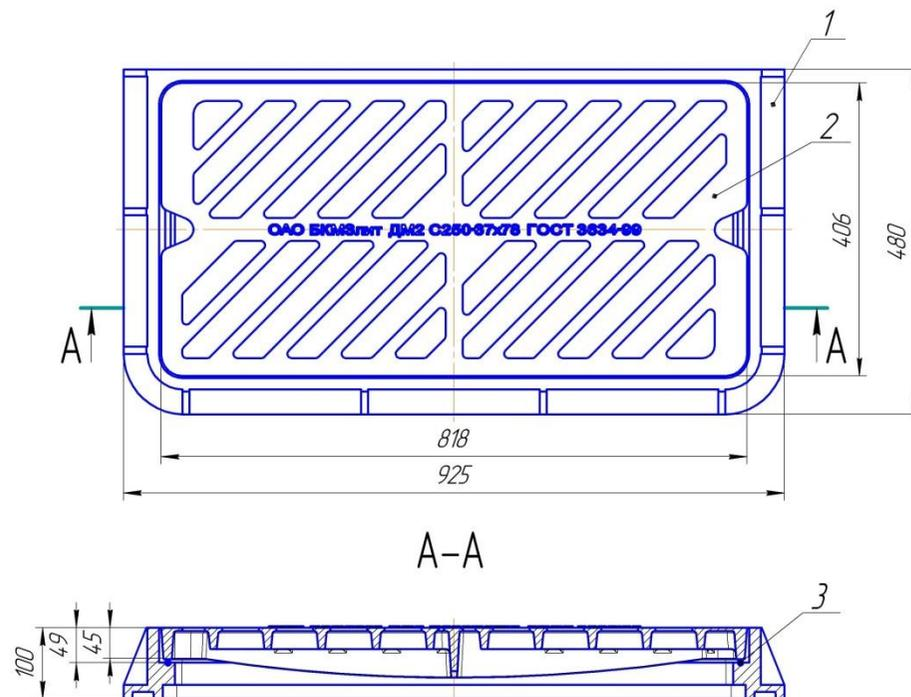
**Рис.1. Дождеприемник магистральный ДМ2-С250-2-37х78**
