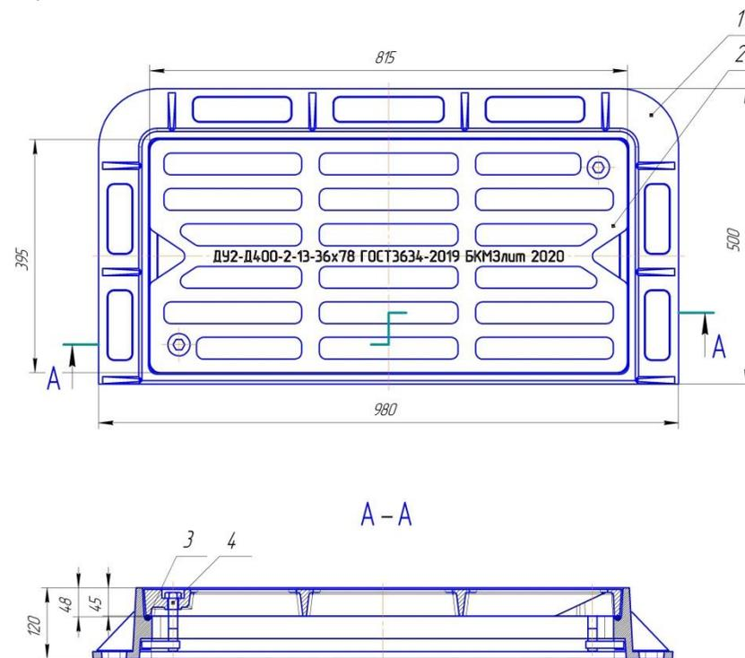
Рис.1. Дождеприемник усиленный ДУ2(Д400)-2-13-36х78
