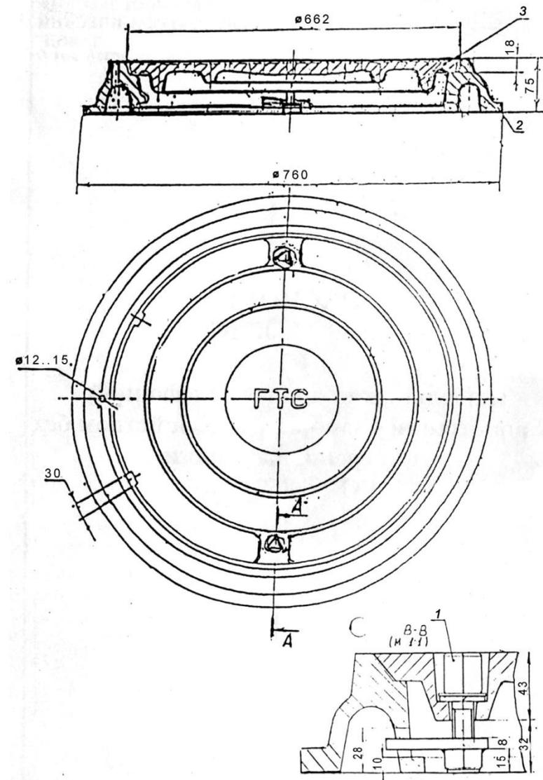
**Рис.1. Люк ГТС-Л с запорным устройством без внутренней крышки**
