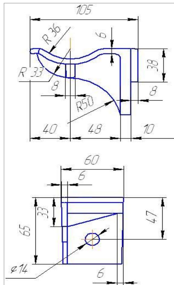
Рис.1. Консоль одноместная кабельная чугунная ККЧ-1
